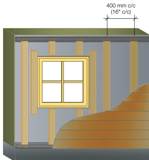
FIGURE 4 • Disposition des fourrures pour le revêtement horizontal
