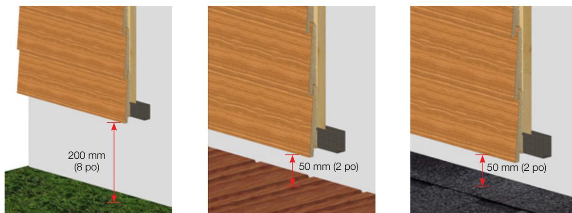
FIGURE 12 • Dégagement minimal du revêtement au-dessus d'une surface
