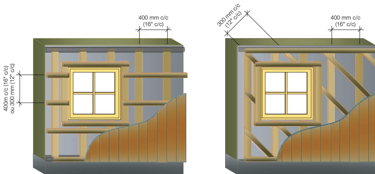
FIGURE 5 • Disposition des fourrures pour le revêtement vertical
