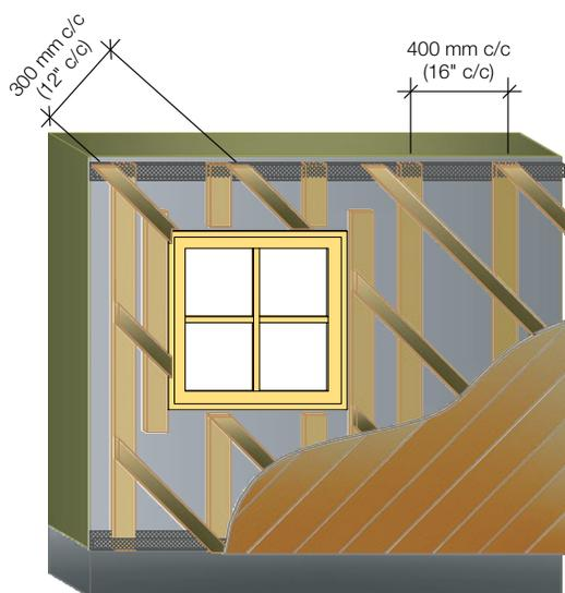
FIGURE 6 • Disposition des fourrures pour le revêtement diagonal
