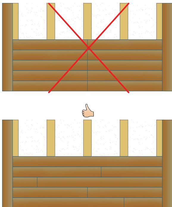
FIGURE 17 • Agencement des longueurs et des joints
